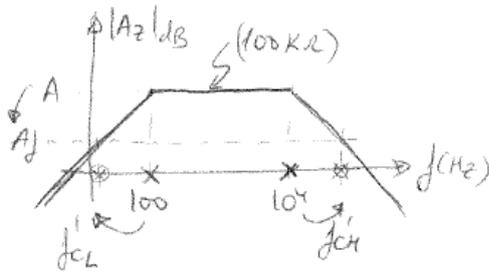
\* De los datos, se deduce que la respuesta en frecuencia del amplificador es como la representada en la figura adjunta.
