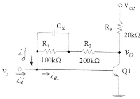
La configuración es paralelo-paralelo esto es: Realimentación de Intensidad, proporcional a la tensión de salida  $\rightarrow \beta y = \frac{i_f}{v_o} (\frac{1}{\Omega})$
