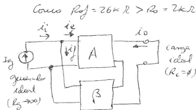
Es una realimentación de corriente proporcional a la corriente de salida.
