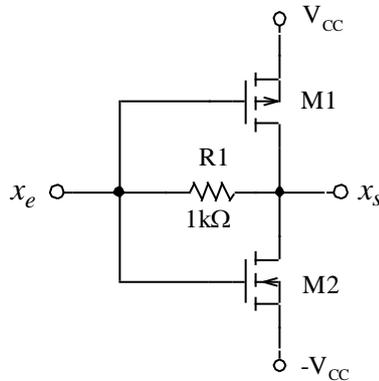
**F-5.-** Observe el amplificador de la figura adjunta ¿qué tipo de realimentación tiene? Encuentre los valores de los parámetros adecuados de la red  $\beta$ , tanto en continua como en señal variable. Considere a  $C_x$  como un condensador de desacoplo.
